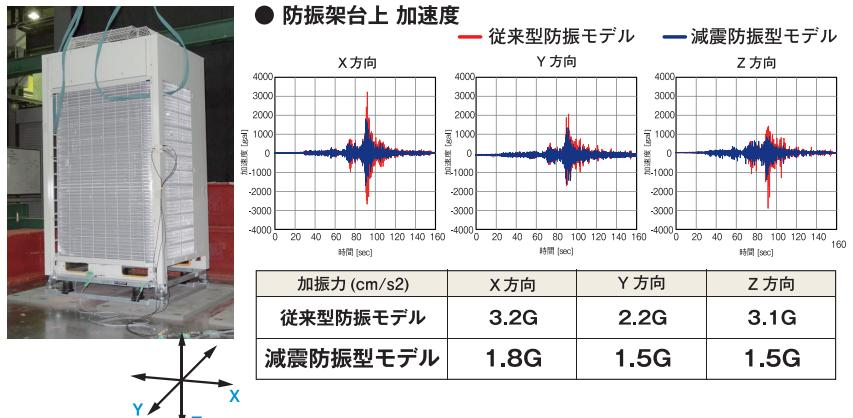
設備機器の損壊規模を震度7クラスから震度5へ低減
