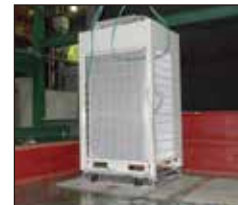
減震効果確認 3次元加振実験
