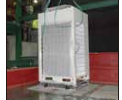
減震効果確認 3次元加振実験
