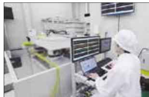
三次元微振動加振台
