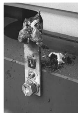
端子部が大揺れし端子部に過電流が流れて溶解
